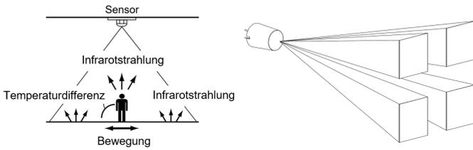
Eine Linse teilt den Erfassungsbereich in 32 Messbereiche auf. Der Sensor erkennt Änderungen der Infrarotstrahlung, welche auftreten, wenn sich ein Objekt\* (oder eine Person) bewegt, dessen IR-Temperatur von der Umgebung abweicht.
